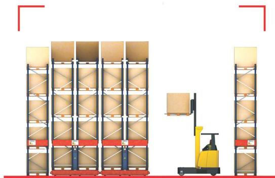
در سیستم قفسه بندی پالتی متحرک (MOBILE RACK)، قفسه بندی ها بصورت فشرده درآمده و ظرفیت انبار به طور چشمگیری افزایش می یابد. ضمن اینکه کماکان امکان دسترسی به تمام پالت ها بصورت FIFO وجود خواهد داشت. در این سیستم، قفسه بندی های پالت رک روی پایه های متحرک نصب می شوندو با حرکت جاتی به دو طرف جایجا می گردند. بنابراین نیاز به راهرو بین تمام ردیف های قفسه بندی از بین خواهد رفت و فقط راهرویی که نیاز به دسترسی قفسه مجاور در آن وجود دارد، جهت گذاشت و برداشت بار باز خواهد شد.
